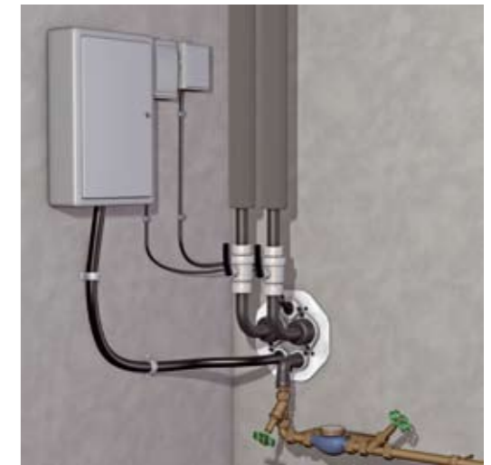
Mehrspartenhausanschluss mit Fernwärme
